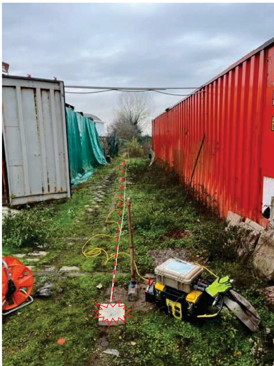
Foto 01 – Stendimento sismico L1 e relativo punto di energizzazione
