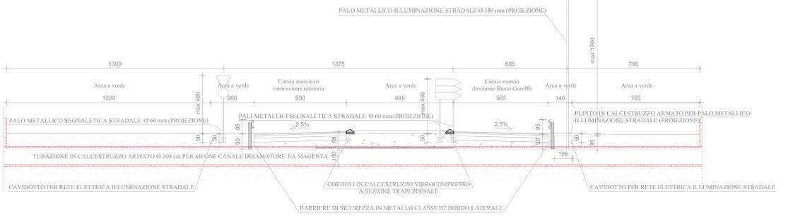
**SEZIONE TRASVERSALE TIPO CON NUOVE CORSIE DI ACCUMULO, IMMISSIONE E PISTA CICLOPEDONALE**
